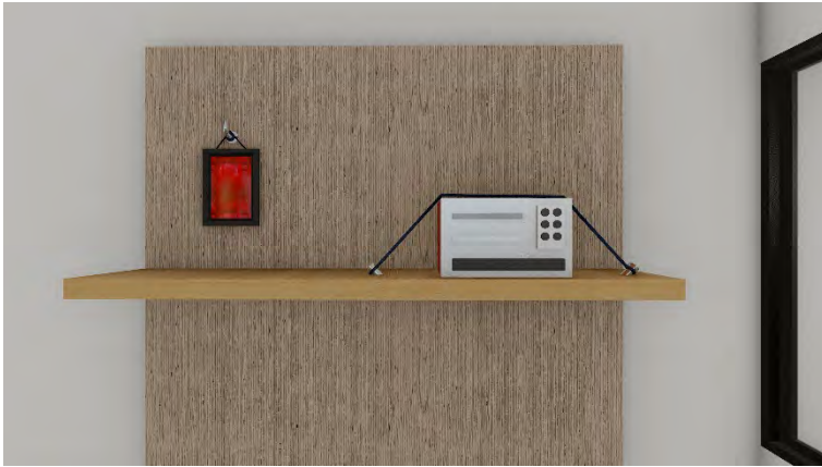
Gambar 7. Komponen non-struktural harus diberi pengaku
