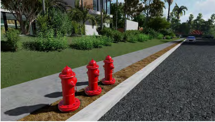
Gambar 9. Ilustrasi penempatan pipa hydrant di jalan
