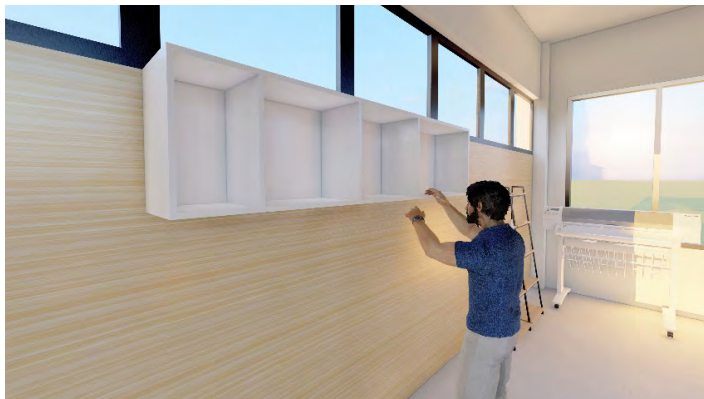
Gambar 4. Ilustrasi pengankuran lemari
