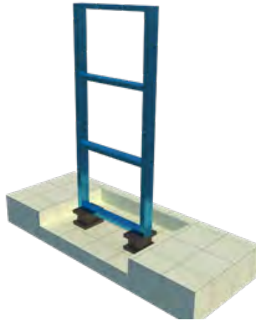
Gambar 8. Ilustrasi struktur yang diberikan isolation bearing
