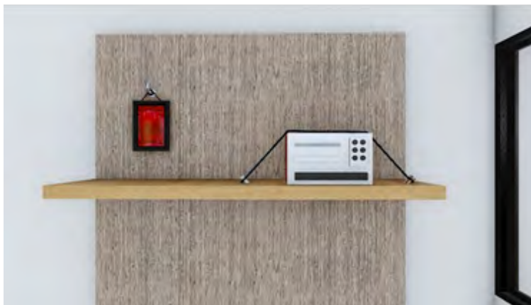
Gambar 7. Komponen non-struktur harus diberi pengaku
