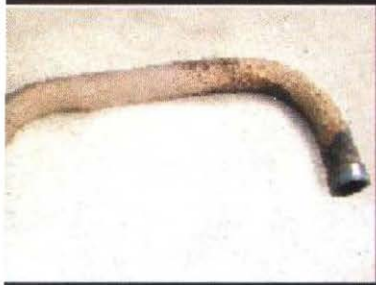
Knalpot Kendaraan Bermotor Terkorosi Akibat Temperatur Tinggi
