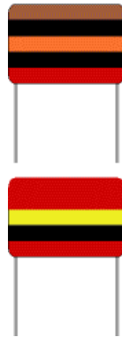
Gambar 2.5. Kode warna pada kapasitor
