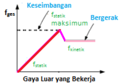
Gambar 3.2.b. Grafik gaya gesek statis, gaya gesek statis maksimum, dan gaya gesek kinetik
