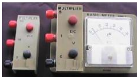
Gambar 1.30. Voltmeter dengan basic meter unit dan multiplier
