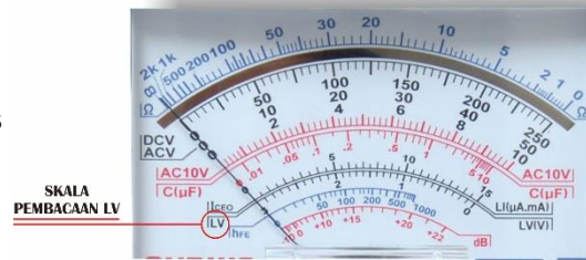
Gambar 1.85. Posisi skala pembacaan LV
