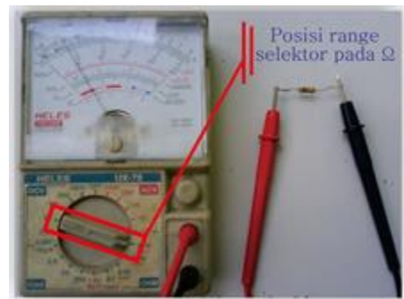
Gambar 1.70. Cara pemasangan ohmmeter
