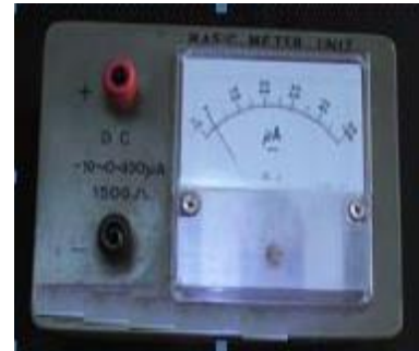
Gambar 1.23. Basic meter unit
