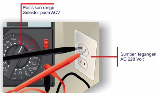
Gambar 1.61. Rangkaian pengukuran tegangan AC jala-jala PLN
