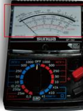
Gambar 1. 49. Fungsi skala multimeter
