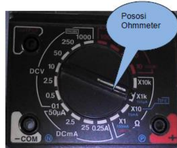
Gambar 1.92. Knob selektor posisi ohmmeter
