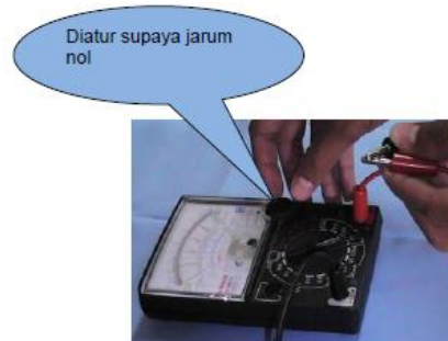
Gambar 1.88. Pengerolan jarum ohm meter
