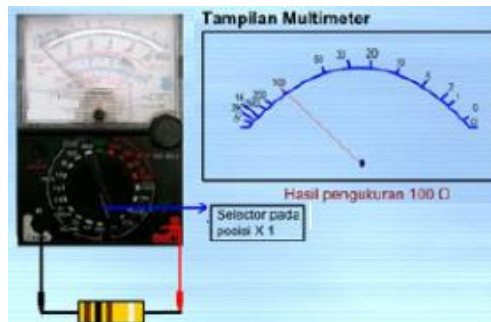
Gambar 1.74. Penunjukan hasil pengukuran ohm
