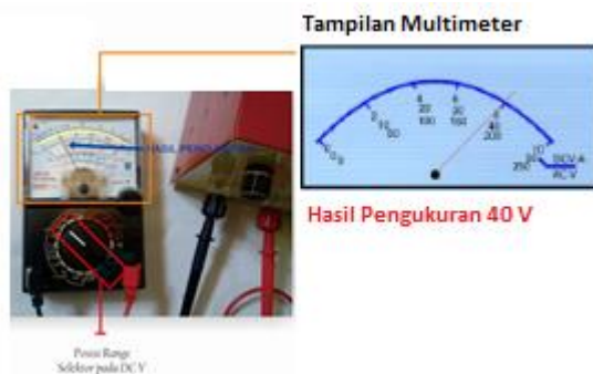
Gambar 1.58. Penunjukan pengukuran tegangan DC
