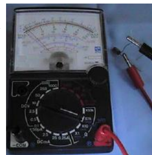
Gambar 1.98. Pengetesan basis kolektor reverse
