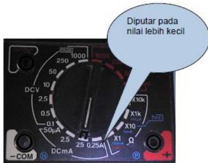
Gambar 1.67. Posisi knob pada range arus DC yang lebih kecil
