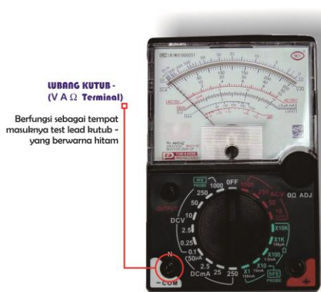
Gambar 1.54. Fungsi lubang kutub (VAΩ terminal)
