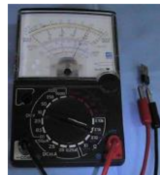
Gambar 1.100. Gate dilepaskan posisi jarum tetap nol
