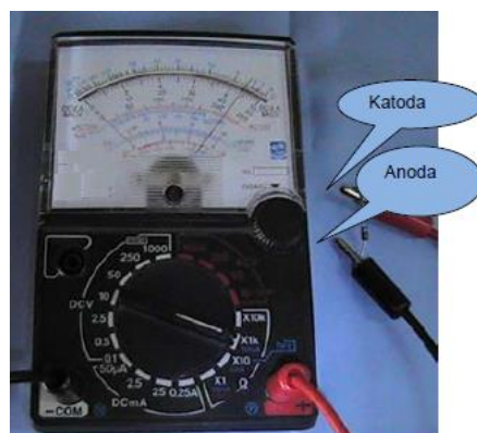
Gambar 1.90. Pengetesan dioda bias maju
