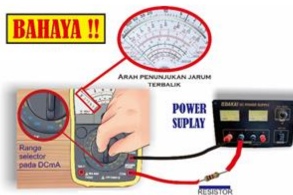
Gambar 1.68. Rangkaian pengukuran arus DC yang salah
