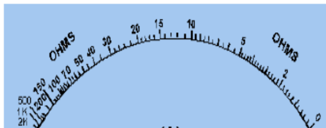
Gambar 1.37. Skala logaritimis pada ohmmeter seri
