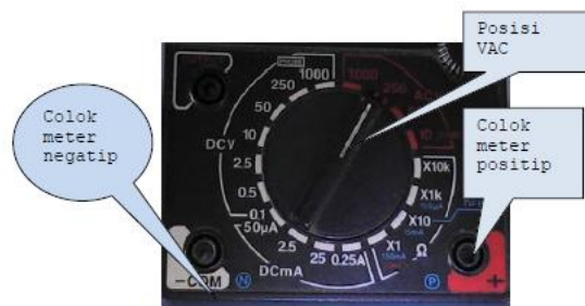
Gambar 1.60. Posisi Knob pada range Tegangan AC
