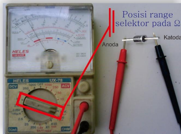
Gambar 1.83. Pengukuran arus IF dioda bias maju
