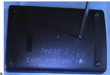
Gambar 1.102. Pelepasan skrup pengunci sekering
