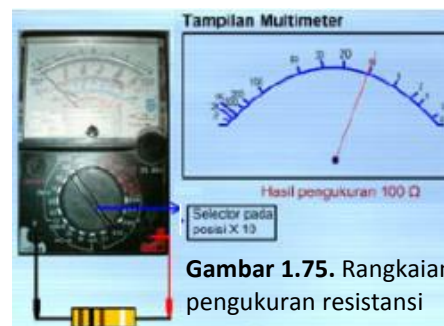
Gambar 1.74. Penunjukan hasil pengukuran ohm
