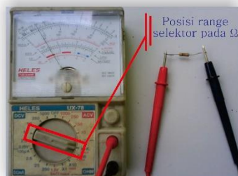
Gambar 1.73. Penempatan resistor pada pengukuran ohm
