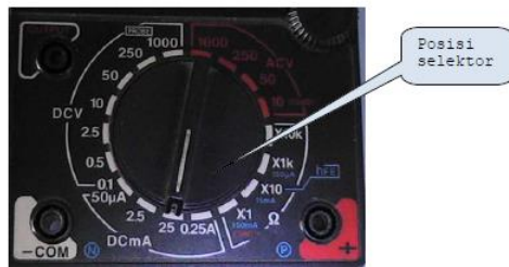
Gambar 1.65. Posisi knob pada range arus DC
