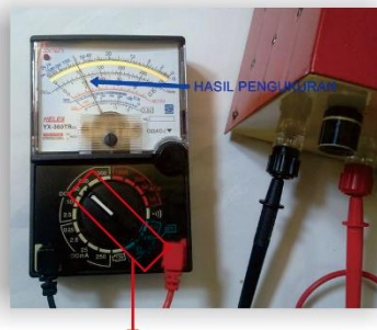
Posisi Range Selektor pada DCV
