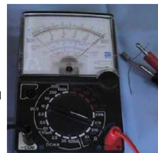
Gambar 1.95. Pengetesan transistor NPN emitor negatif meter nunjuk nol
