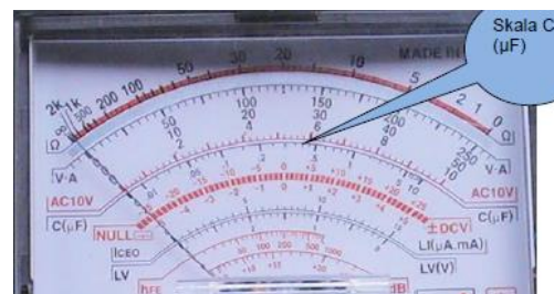
Gambar 1.87. Posisi skala kapasitor
