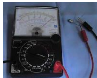
Gambar 1.95. Pengetesan transistor NPN emitor negatif meter nunjuk nol
