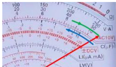
Gambar 1.86. Gerakan jarum pengukuran Kapasitor
