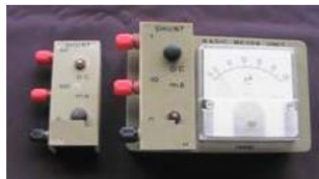
Gambar 1.25. Ampermeter dengan basic meter unit
