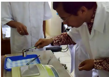
Gambar 1. Kegiatan pengukuran massa anak timbangan di laboratorium kalibrasi PPPPTK IPA Bandung
