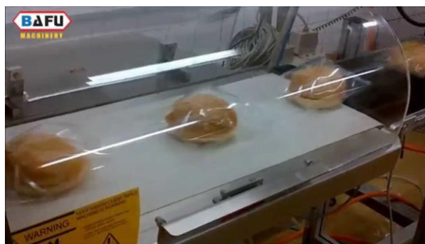
Gambar 20. Alat pengemas roti otomatis. www.youtube.com
