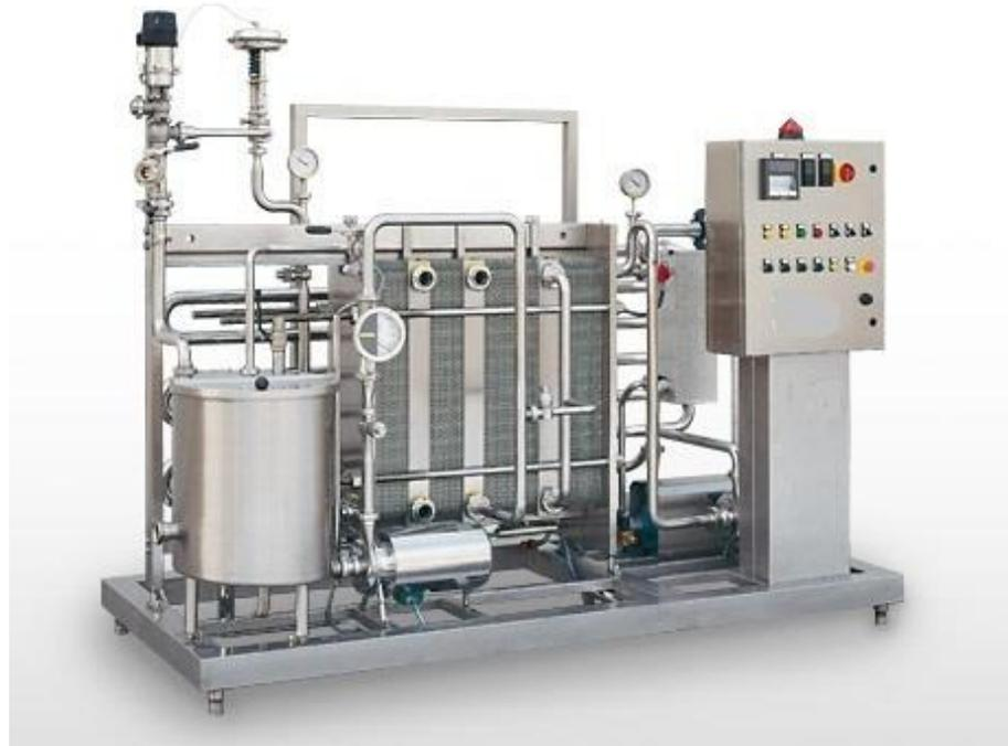
Gambar 6. Mesin pasteurisasi (pasteurizer)
