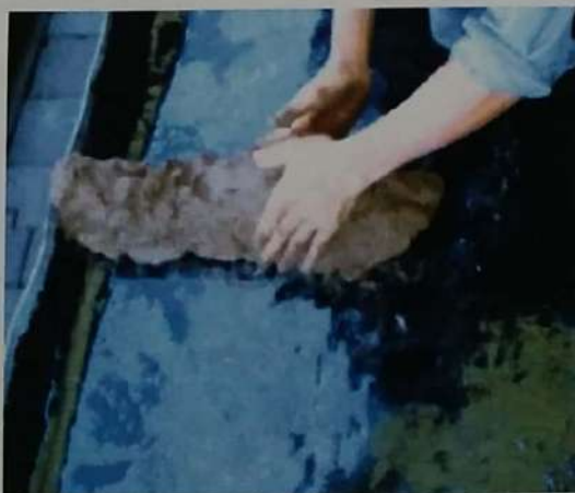
Foto 25. Pembuatan batas-batas atau kolam pengetesan kebocoran/rembesan
