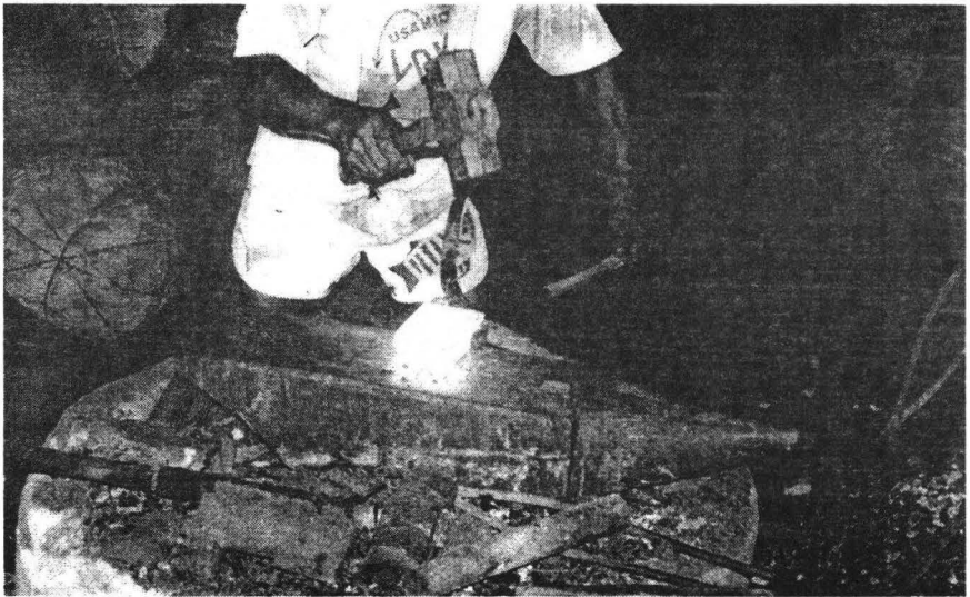
Proses penempaan bahan Saton dan baja yang sudah menyatu.
