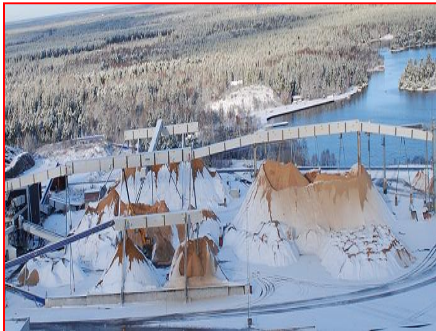
Gambar 5. Penimbunan bahan bak dibawah travelling bridge (jembatan pembawa)( www.bulk handling )
