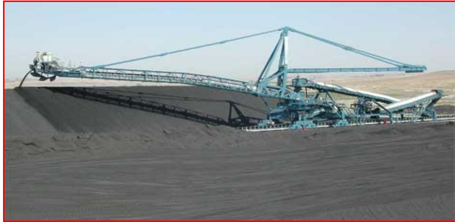
Gambar 6. Penimbunan dikiri dan kanan jalan lokomotive crane. ( www.bulk handling )
