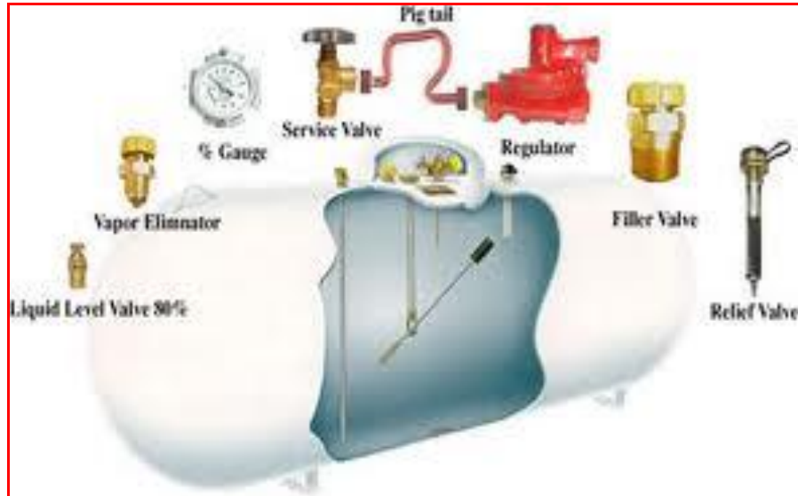
Gambar 21. Peralatan kontrol dan safety pada tangki bahan bakar cair. ( www.bharattanksandvessel.com ).
