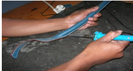
Gambar 2.176. Finishing dengan solder Sumber. PPPPTK Seni dan Budaya
