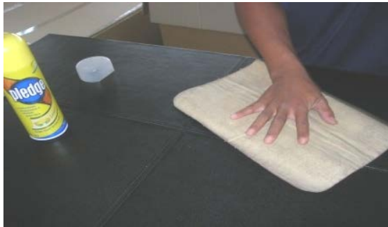
Gambar 2.178. Finishing menggunakan silicon Sumber. PPPPTK Seni dan Budaya
