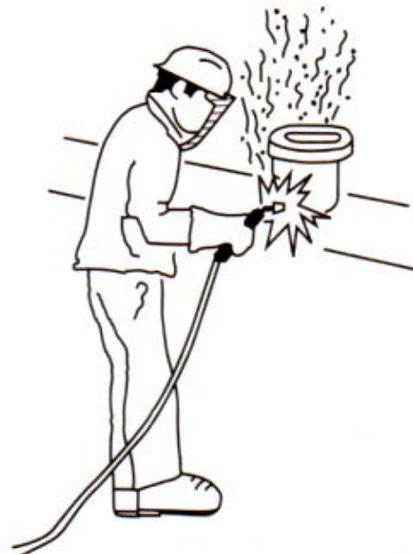
Benar ..... (lokasi pengelasan di sisi/setinggi dada)
