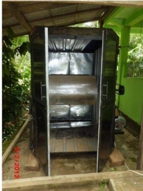
Gambar 12. Mesin Pengering Tanaman menggunakan Listrik PLTMH
