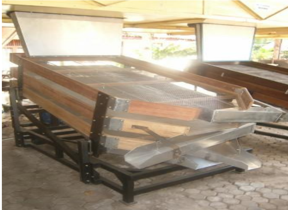
Gambar 15. Alat sortasi dan grading dengan saringan bertingkat
