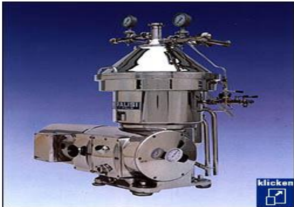
Gambar 21. Alat sortasi dan grading dengan sistem sentrifugal
