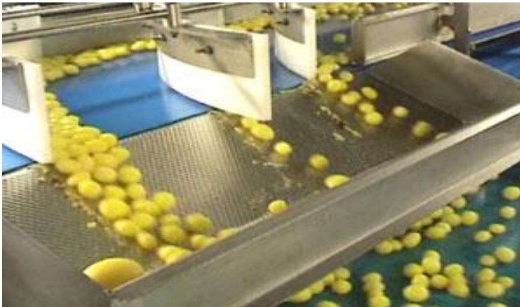
Gambar 3. Kegiatan sortasi dan grading buah-buahan menggunakan perangkat mesin
