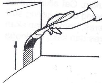
Penguasan cat pada bagian sudut dalam kerja dilakukan dengan **metode penguasan lepas sudut**. metode ini dilakukan dengan
