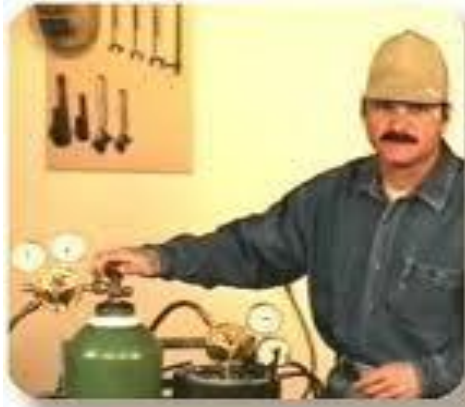
Gambar 3.01 Pemasangan dan Pengecekan Sambungan
